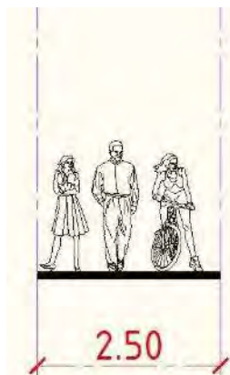
Attēls 30 "Tipveida šķēršprofils apvienotajam gājēju un velosipēdu ceļam"
