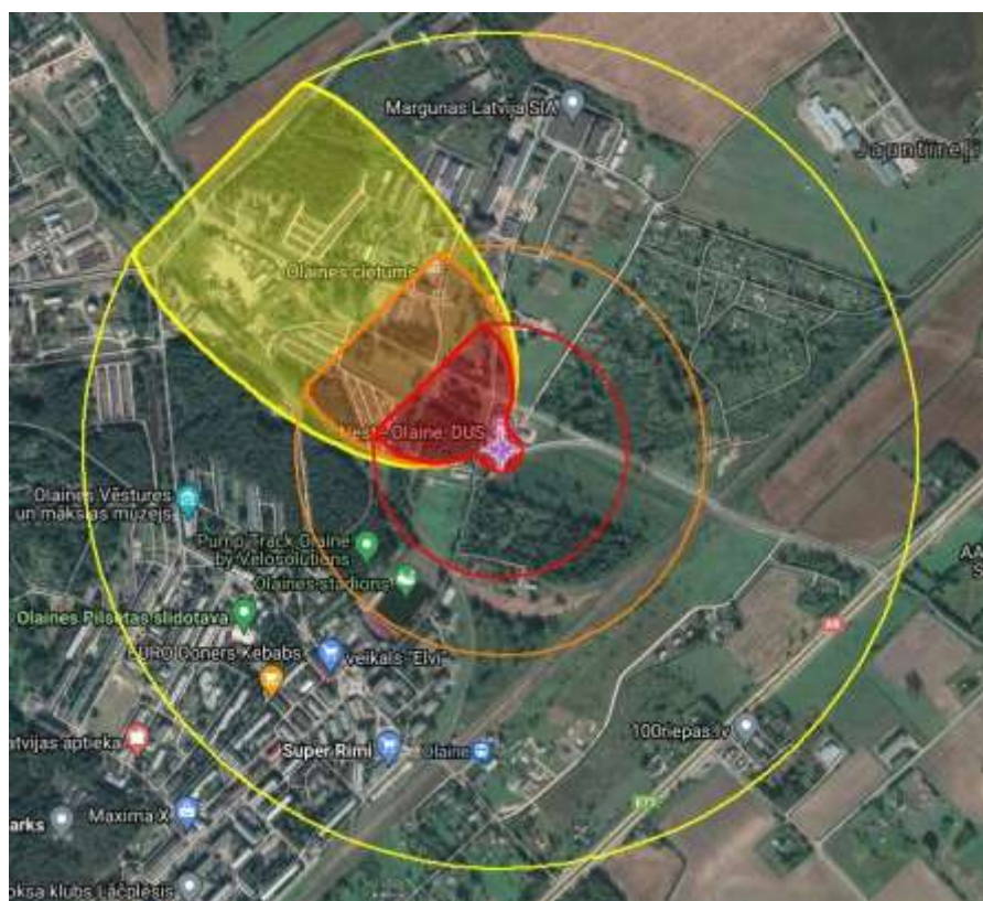
20. attēls Benzīna noplūdes no DUS toksisko tvaiku izplatības zona
