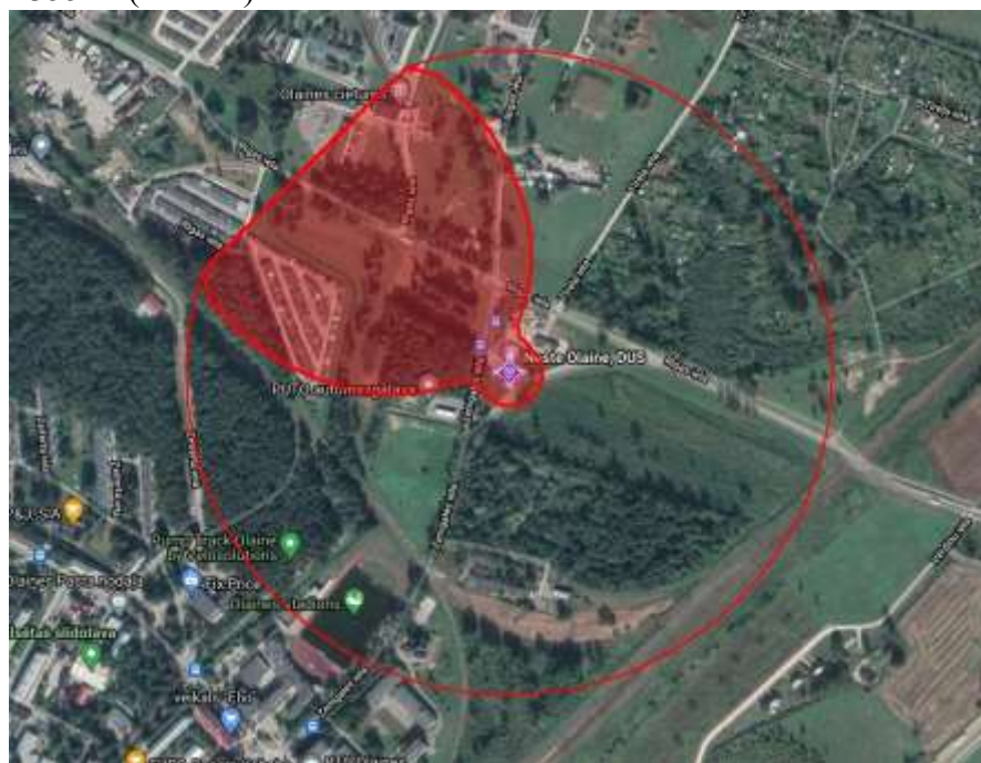
21. attēls Benzīna noplūdes no DUS Toksisko tvaiku izplatības zona
