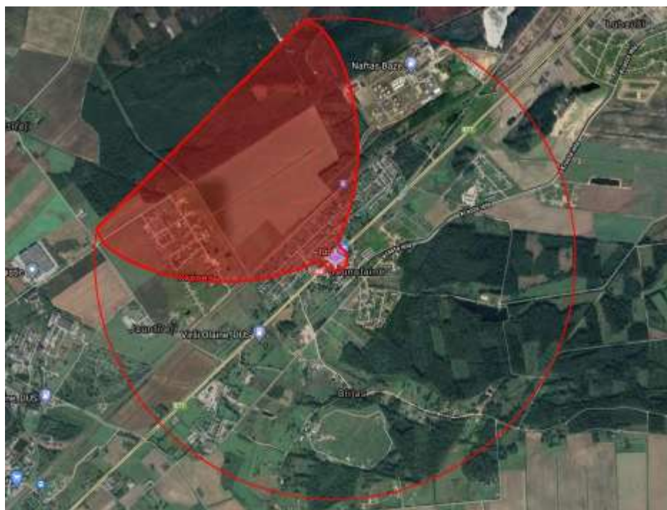
43. attēls Sašķidrinātās naftas gāzes noplūdes no autocisternas toksisko tvaiku izplatība
