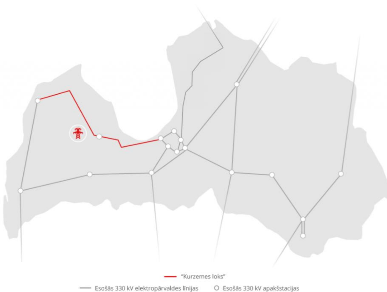
39. attēls. Esošās 330 kV augstsprieguma līnijas Latvijā [AS “Augstsprieguma tīkli”]
